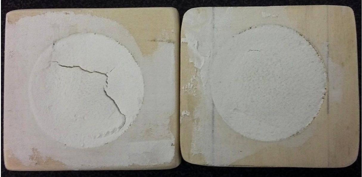
Links: 0-Probe mit 5mm Schichtstärke (Dispersionsacrylpachtelmasse)
