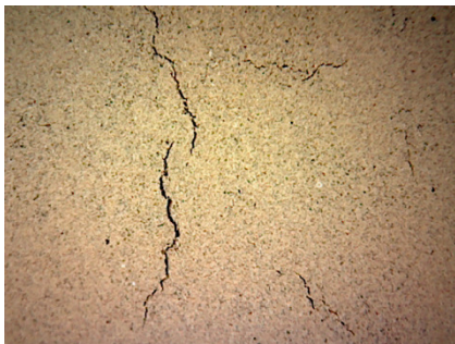
Schwundrissbildung bei hoher Schichtstärke: 0-Probe
