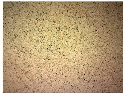
Schwundrissbildung bei hoher Schichtstärke: 0,75% Armipent 542
