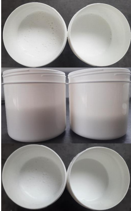
Abbildung 3: Vergleich der Schaumbildung nach der Einarbeitung in ein wässriges Bindemittel, von Zn-Stearat mittels Dissolver ohne Vakuum (links: Zn-Stearat Pulver; rechts: Zn-Stearat Paste).
